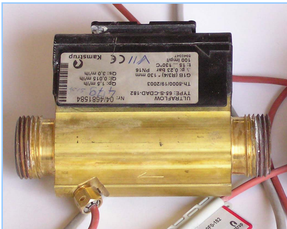
Direkt merülő hőmérséklet érzékelő az átfolyás mérőben (A képen látható 65S-CDAD típus kifutott. 2008 novemberétől az ULTRAFLOW® 54 sorozat váltotta fel, de a technológiai megoldás nem változott.)
